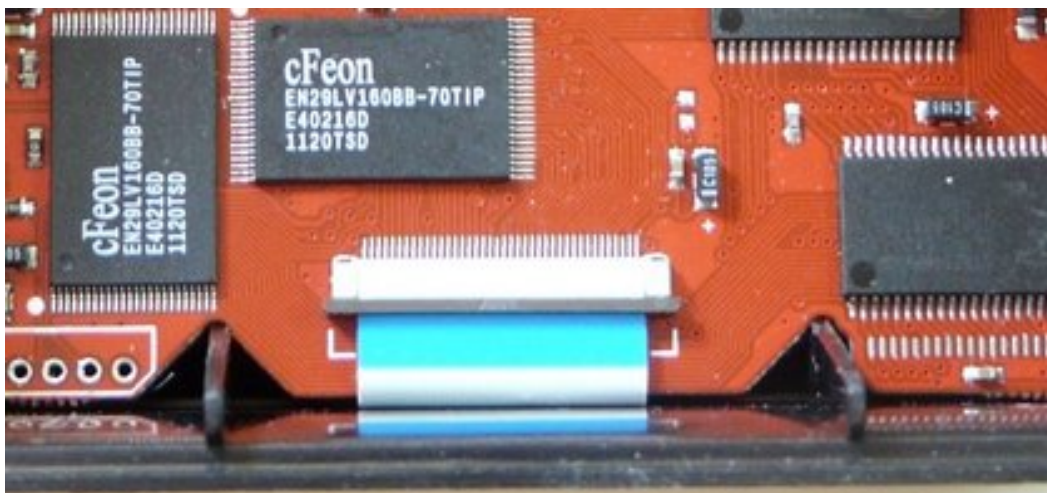
Slika 2. – konektor za povezivanje fiskalne memorije
